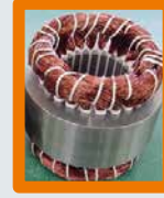
Dağınk tip motor sargısı
